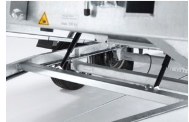
Brücke mit speziellem Kipp-lager
