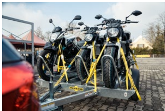
3 Standschienen mit Bügel montiert
