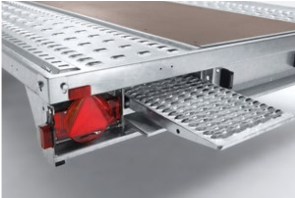
Im Bohlenschacht einschiebbare feuerverzinkte Stahlbohlen
