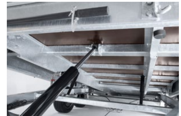
Besondere Stabilität durch Doppelhutprofile in Querrichtung an der Brücke
