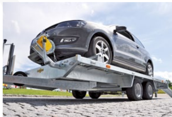
Stabiler Grundrahmen aus gekanteten Stahlprofilen
