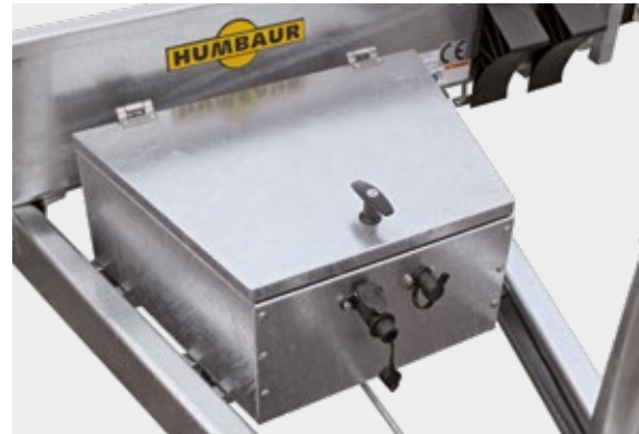
Deichselbox zum Schutz der Batterie und der Absenkhraulik
