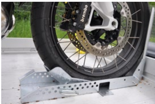
Optionale Motorradwippe zur Festmontage auf der Ladefläche
