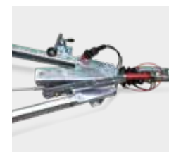
links Im Tauchbad feuerverzinkte Zugdeichsel rechts In den Seitenbordwänden integrierte Zurringe
