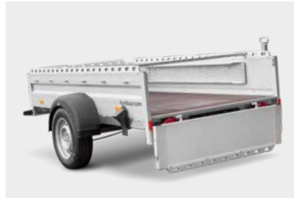
Klappe mit versenkten Verschlüssen
