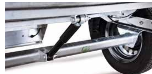
Kippbarer Kastenaufbau (beim HA kippbar) mit Stoßdämpferunterstützung
