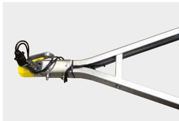
Feuerverzinkte V-Zugdeichsel mit Querstrebe
