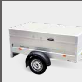
Holz-Alu-Deckel bei Grundbordwand
