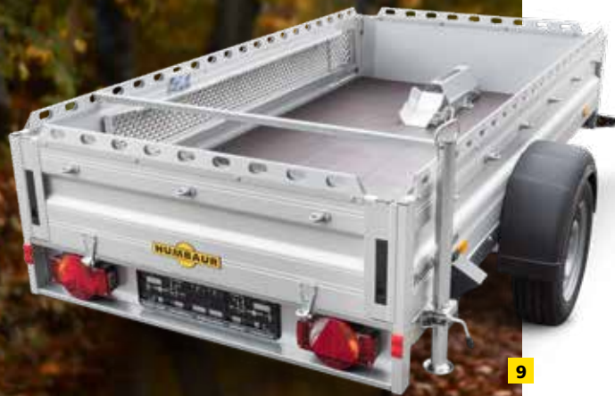
In den Seitenbordwänden integrierte Zurringe (6 Stück) serienmäßig
