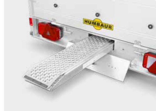
Optionale Alu-Auffahrschienen im Unterfahrschutz einschiebbar
